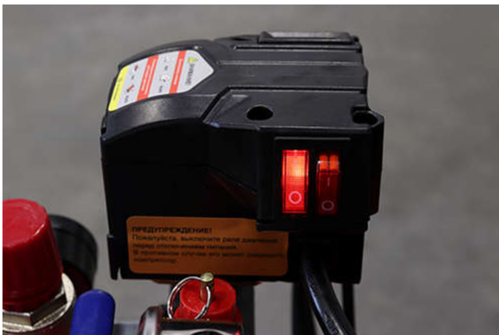
2 режим - 1/2 производительности (250л/мин; 1.45кВт)
