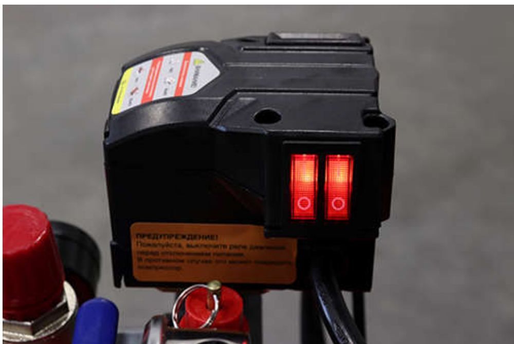
1 режим - максимальная производительность (500л/мин; 2.9кВт)
