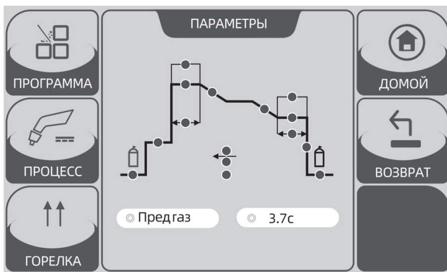
Рис. 15. Настройка параметров сварочного процесса
