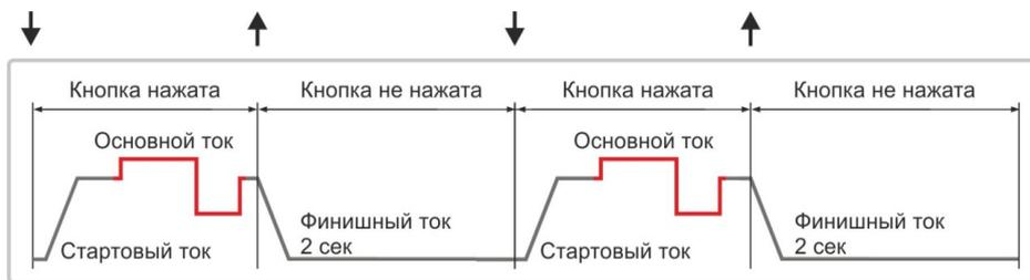
Для 4-тактного режима работы горелки повторяется следующий алгоритм:
